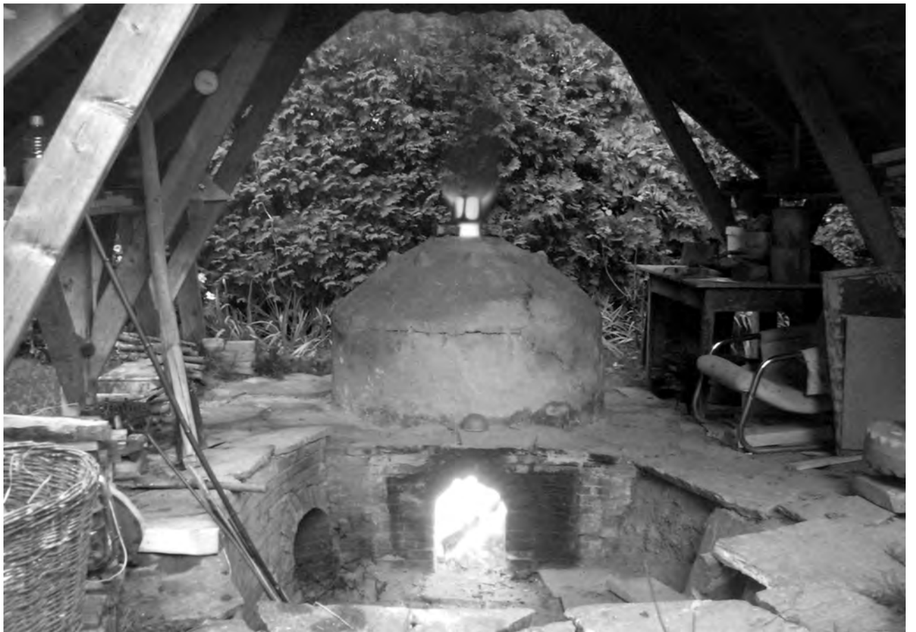
Un des fours gallo-romains de Pierre-Alain Capt en pleine action. On aperçoit bien la flamme d'échappement, élément essentiel et incontournable pour le contrôle des températures et des atmosphères de cuisson
