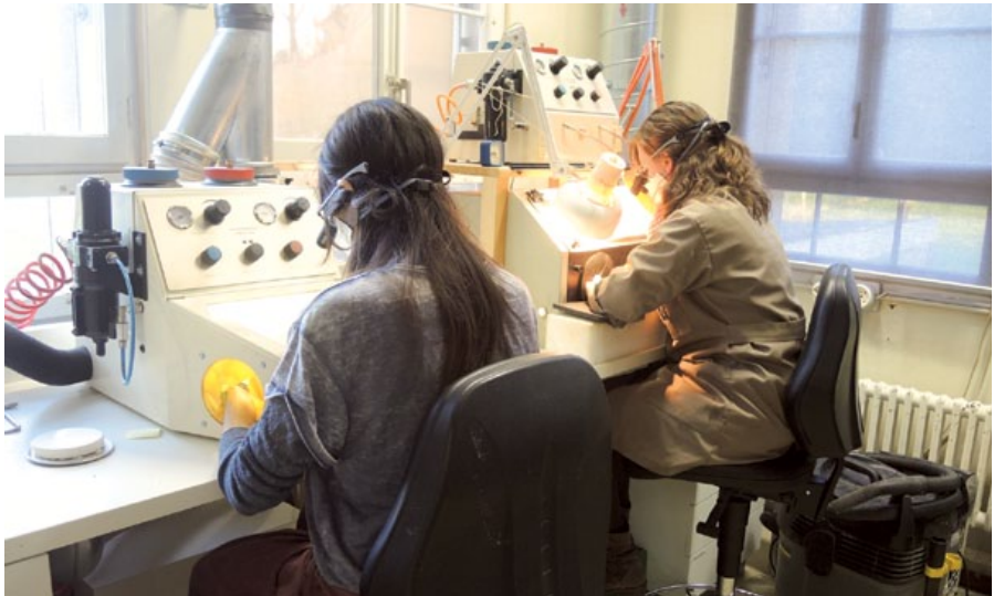
Fig. 14 – Maïssane Farra et Laura Andrey dégagent des objets en fer sous la loupe, à l'aide de microsableuses
