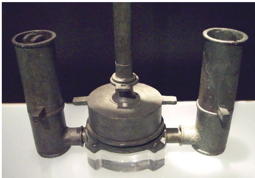
Vue partielle d'un mécanisme de pompe antique en alliage cuivreux découvert dans une mine de la région d'Huelva en Andalousie. L'élément découvert à Avenches correspond à l'un des deux cylindres latéraux d'un dispositif analogue
