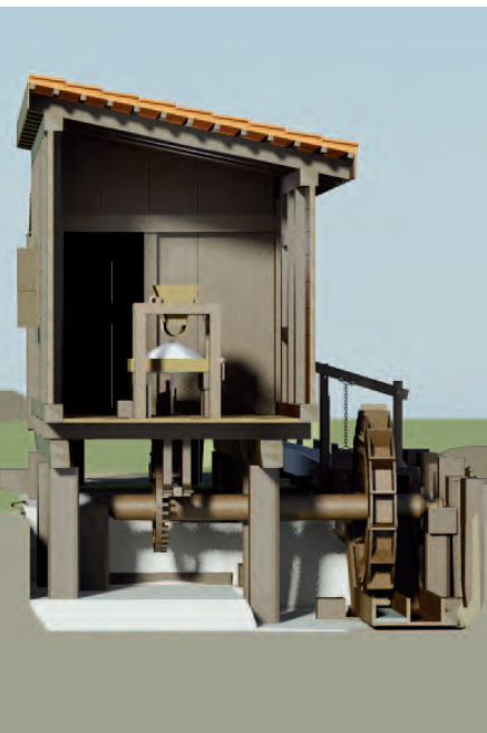
Abb. 172 – Querschnitt durch die Mühle von Les Tourbières. Die Mahlkammer, in welcher der Mühlstein dreht, befindet sich auf einer erhöhten Plattform. Unter dem Holzboden liegt das Räderwerk, das durch das Wasserrand angetrieben wird (rechts).
