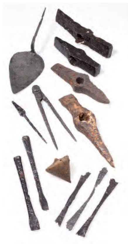
Fig. 36 – Sélection d'outils utilisés dans différents domaines de la construction (truelle, marteaux, pics, mèche, compas, fil à plomb, ciseaux droits et spatules).
