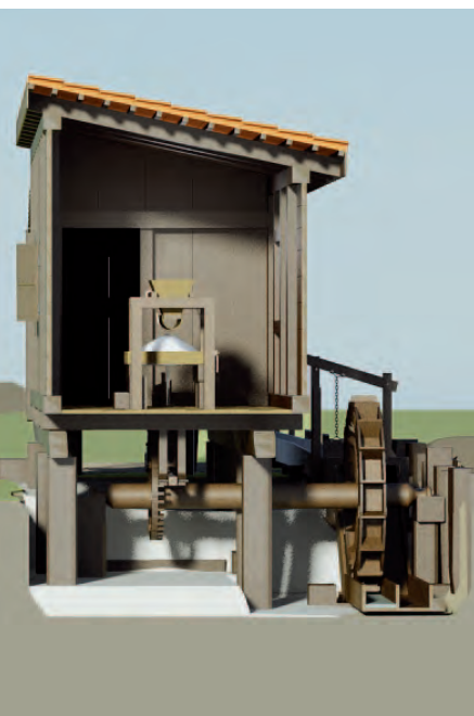
Fig. 172 – Coupe transversale du moulin des Tourbières. La chambre de meunerie, où tourne la meule, est établie sur une plateforme surélevée. Sous son plancher, se trouve l'engrenage mû par la rotation de la roue hydraulique (à droite).
